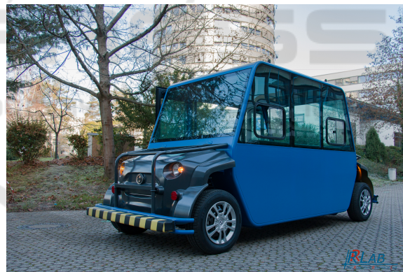
Figure 1: Driver-less bus model planned to drive in Technische Universität Kaiserslautern.
